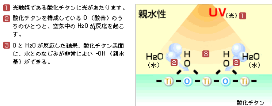
図1 2. 光触媒による親水性効果の原理（出典：光触媒工業会資料）
