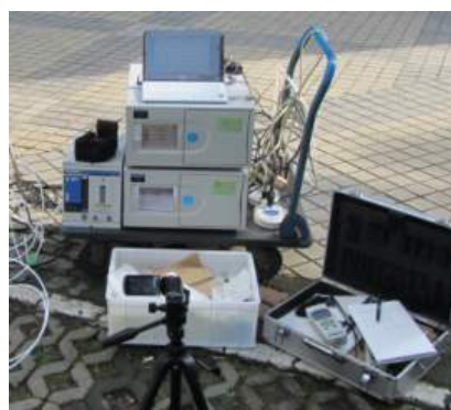
図3. 窒素酸化物濃度測定装置 APNA-370 (堀場製作所)
