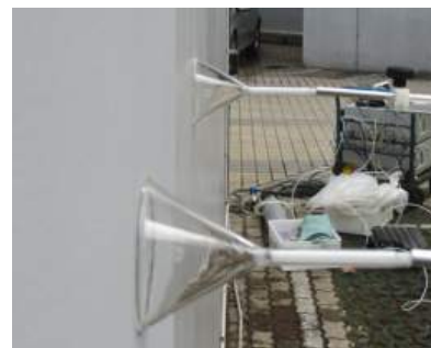
図2. サンプルング ~ 壁面近傍 (吸気口と壁面の距離 約1mm) の空気をサンプルング
