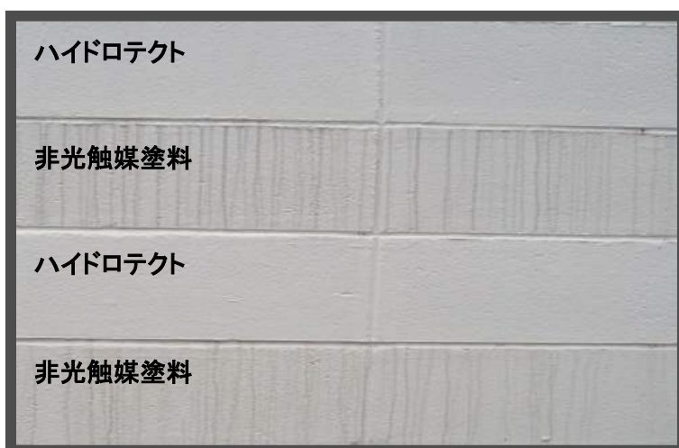
図 9. ハイドロテクト塗料と非光触媒塗料の曝露実験（屋外暴露、期間：1年）
